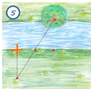
Der letzte Schritt besteht darin, die Strecke zwischen Groma und dem letzten Stab zu messen. Die Länge der Strecke entspricht der Flussbreite.
