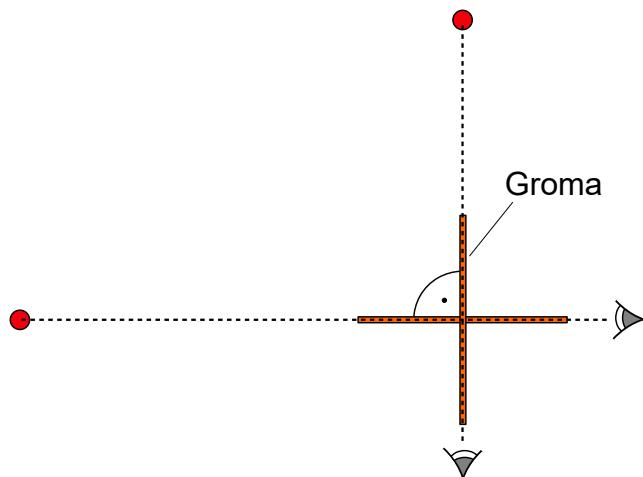
Zunächst wird das Groma so aufgestellt, dass eine Flucht zu dem Baum auf der gegenüberliegendes Seite des Flusses führt. Die andere Flucht geht am Flussufer entlang. Auf dieser Flucht wird ein Stab an beliebiger Postion aufgestellt. Ein zweiter Stab wird so aufgestellt, dass er die Strecke zwischen dem ersten Stab und dem Groma halbiert.
