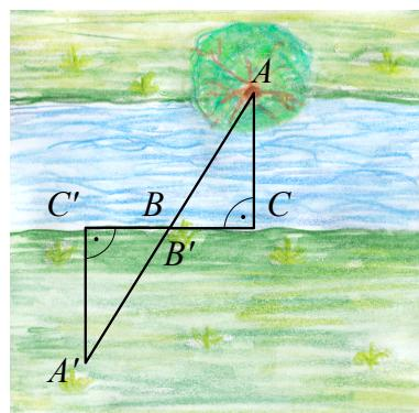
Die beiden Dreiecke sind kongruent und es gilt sogar  $\overline{AC} = \overline{A'C'} \wedge \overline{BC} = \overline{B'C'}$ . Die Strecke  $\overline{A'C'}$  kann abgemessen werden und entspricht der Breite des Flusses.
