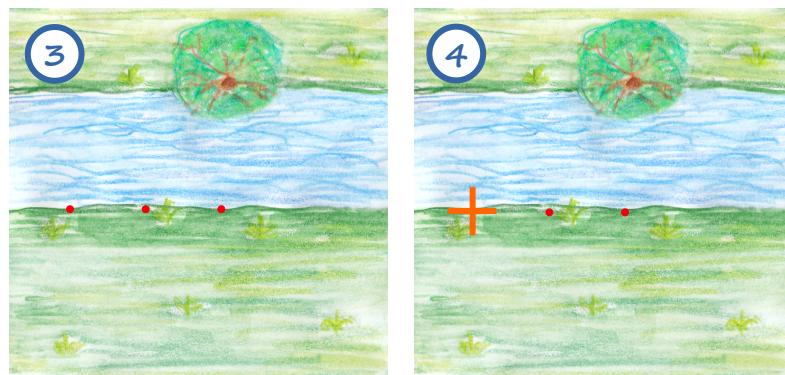
Schließlich wird ein letzter Stab so positioniert, dass er in der Flucht des Groma und gleichzeitig in der Flucht des mittleren Stabes und dem Baum steht.
